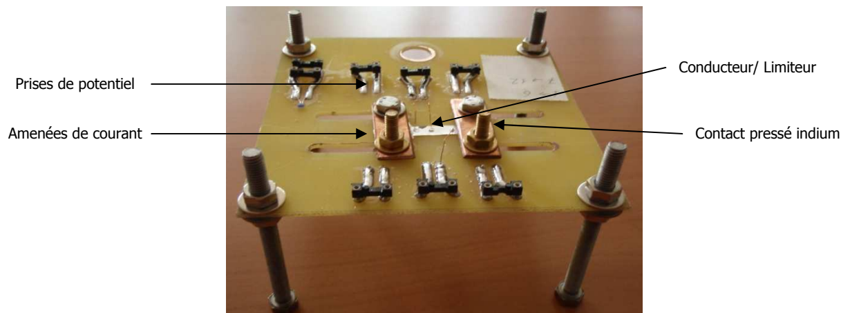
Figure 4.4 Conducteur déposé sur son support – Tung Nguyen
