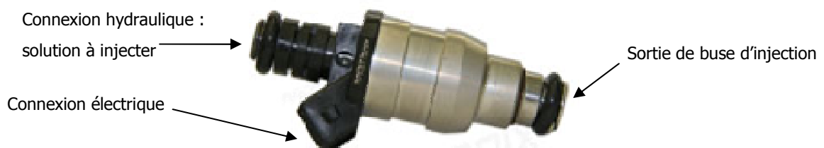
Figure 1.23 Représentation d'un injecteur Bosch EV6
