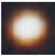
Figure I-8 : Lumière émise par différentes multicouches sous un éclairage ultraviolet. La couleur change avec l'épaisseur de la couche de silicium ( e_{Si} ): 3 nm pour l'émission rouge, 1,2 nm pour l'orange et 0,6 nm pour le jaune.
