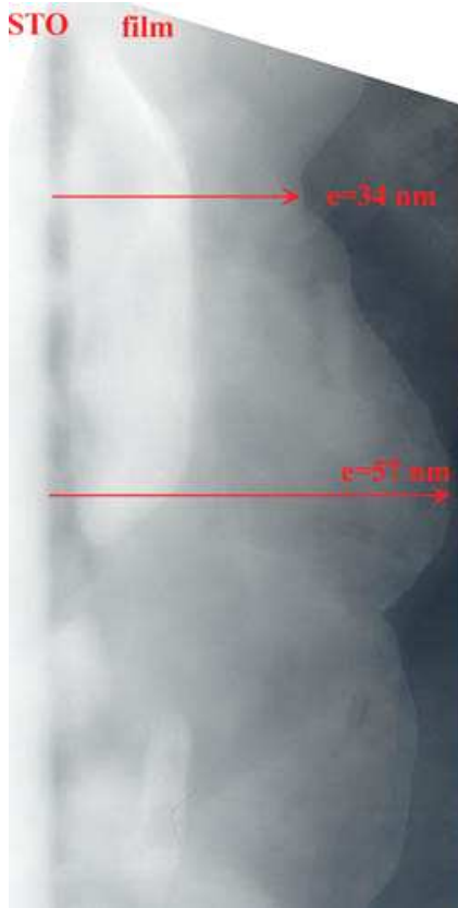
c) image MET et cliché de diffraction pour un film obtenu à T=600^{\circ}\text{C}
